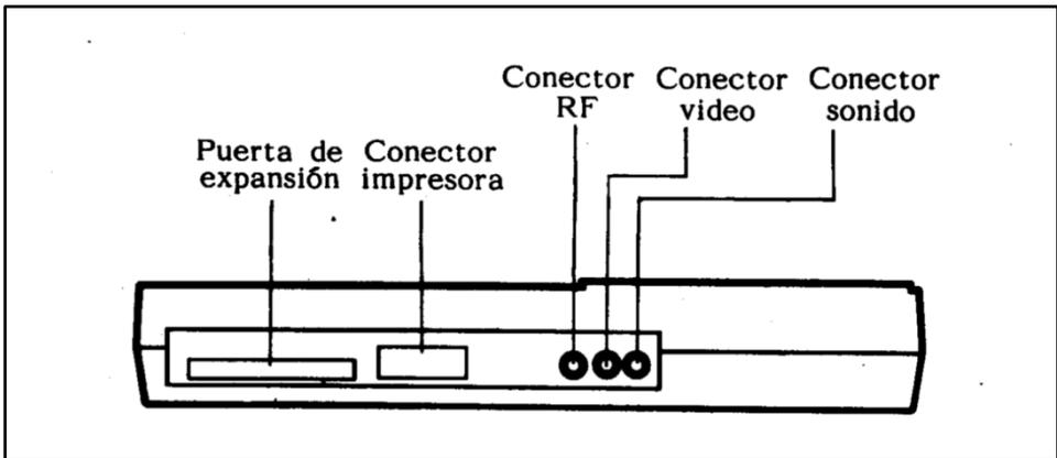
**Puerta de expansión:** Conecta un periférico externo a la computadora.
