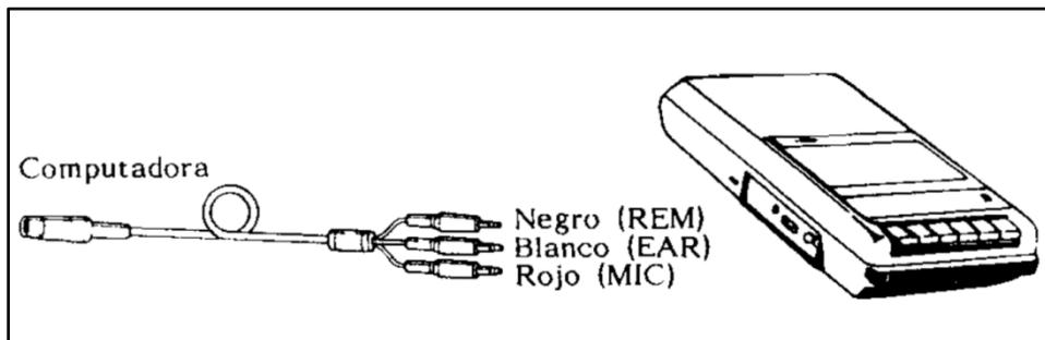
Conecte el enchufe de 8 contactos DIN en el lado correspondiente de la computadora.
