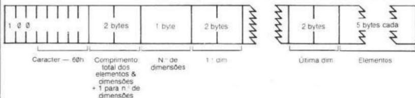
A estrutura de uma variável de controlo para um ciclo («loop») FOR/NEXT é ilustrada na Fig. C-6.
