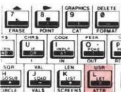
USR é a função que está situada acima da tecla L. Supondo que pretendemos formar um novo caracter na tecla E, utilizamos USR "E" para indicarmos ao computador exactamente o início da memória (endereço) onde está localizado o UDG (User Defined Graphic) E.
