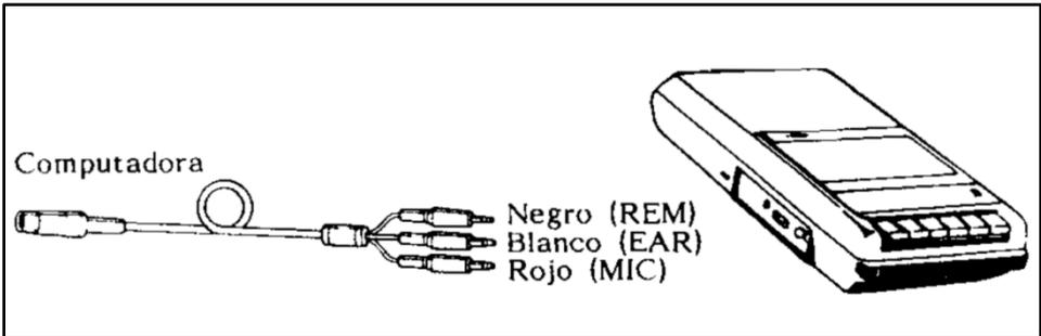
Conecte el enchufe de 8 contactos DIN en el lado correspondiente de la computadora.
