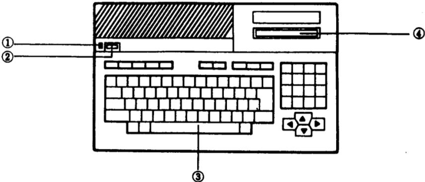
1. Indicador luminoso. Se enciende cuando la computadora está enchufada y el interruptor de encendido se pone en "ON".
