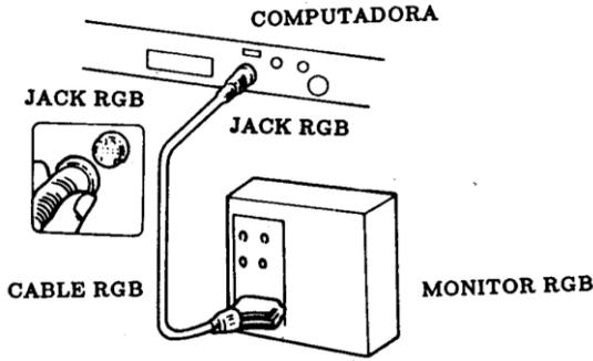
Conecte el cable RGB en la forma indicada en la figura. Coloque el selector mono/color en la posición color.
