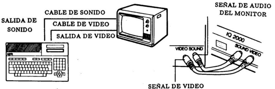
Conecte el monitor de la computadora en la forma indicada en la figura. Coloque el selector color o monocromático en la posición que corresponda al monitor en uso.
