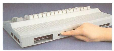
2. SET THE CHANNEL SELECTOR SWITCH ON THE BACK OF THE COMPUTER.
